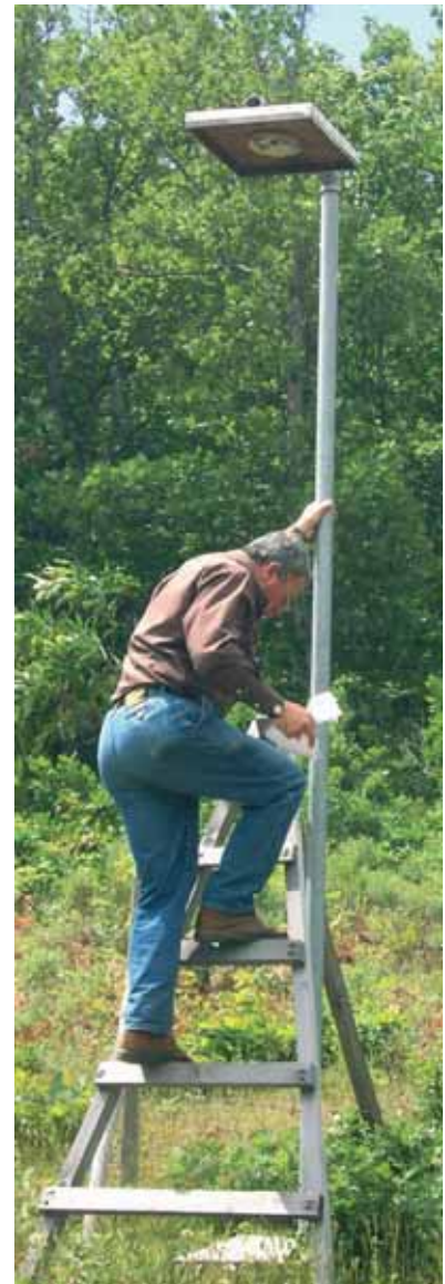
Dosímetro pasivo de ozono instalado en una parcela de Nivel II en el Centro-Este de Grecia.
