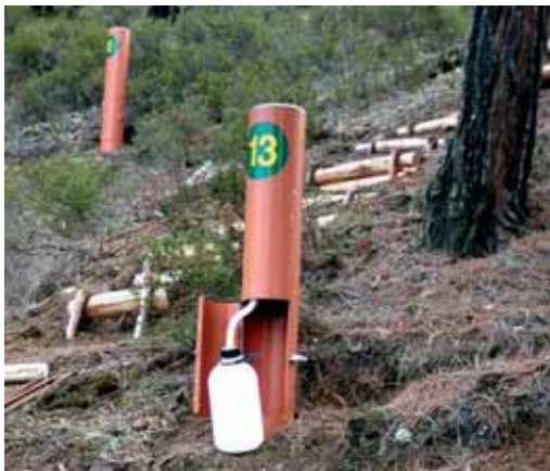
Colector de deposición bajo el dosel de las copas en Chipre y colector a cielo abierto en Noruega.
