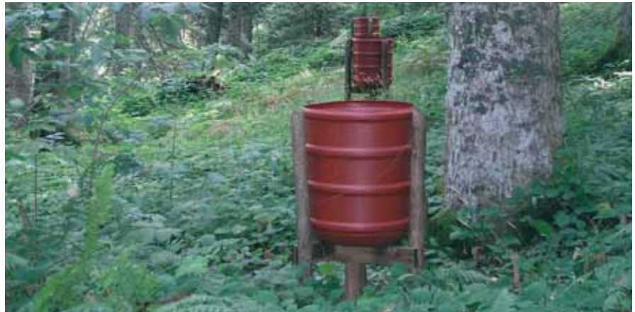
Colectores de desfronde instalados en una parcela de Nivel II de abeto en Grecia central.
