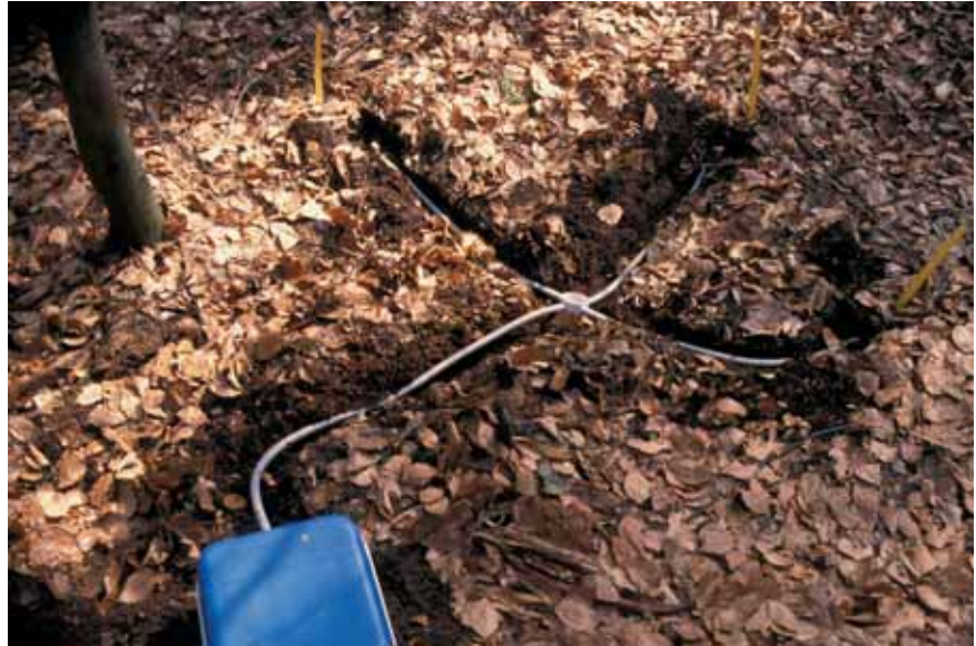
Lisímetros extrayendo solución del suelo en Francia.
