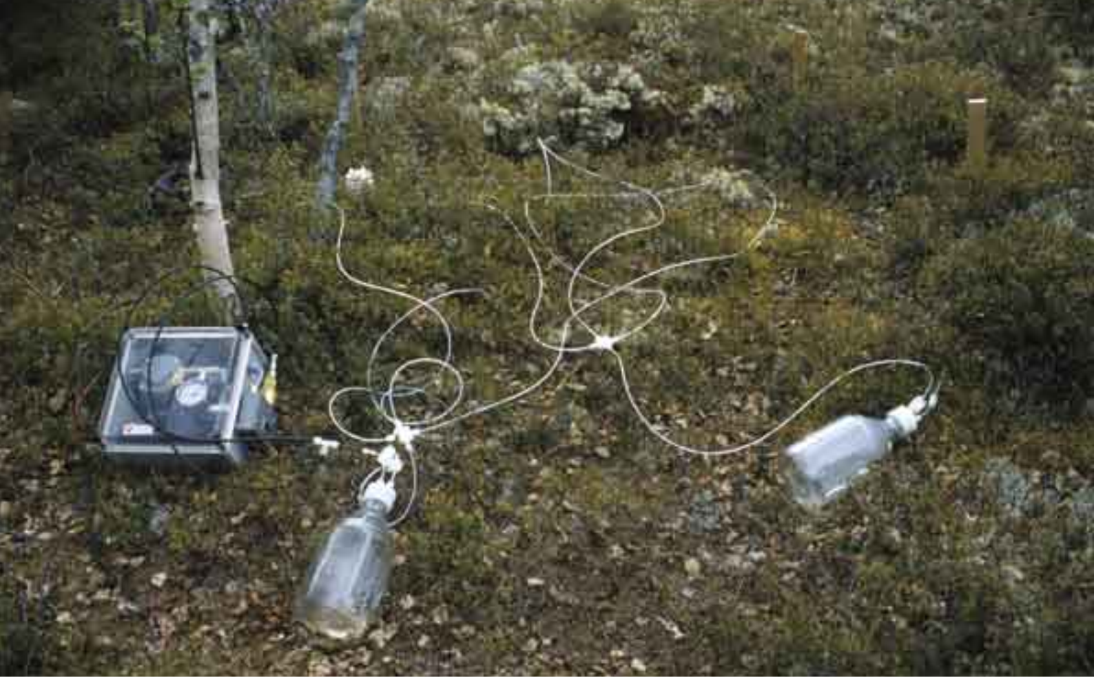
I lisimetri raccolgono acqua direttamente dai diversi strati del suolo
