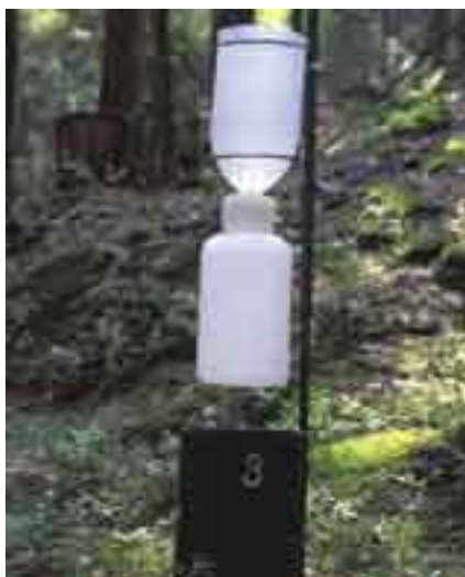
Attrezzatura di misura per la raccolta della deposizione umida in un popolamento forestale
