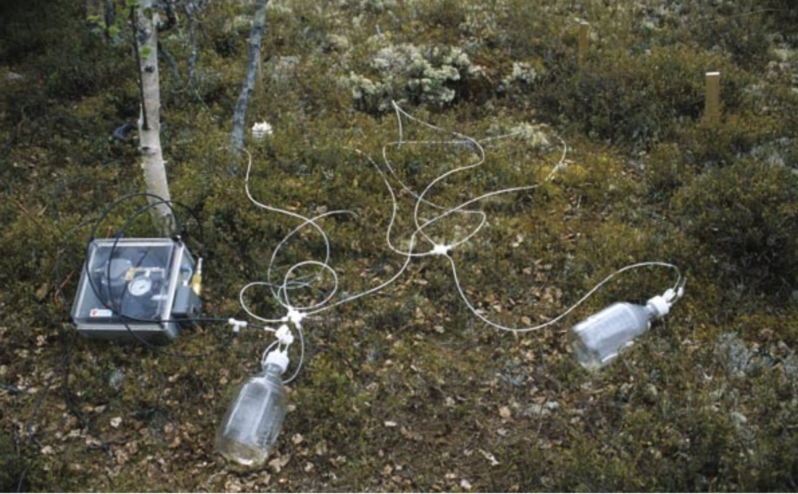
Des lysimètres extraient de l'eau de différentes couches du sol
