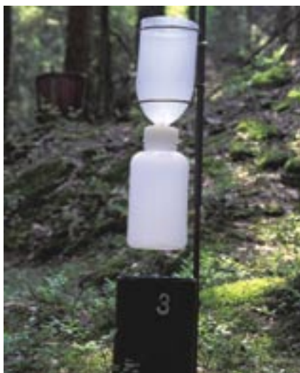
Équipement de mesure des dépôts humides dans les peuplements forestiers
