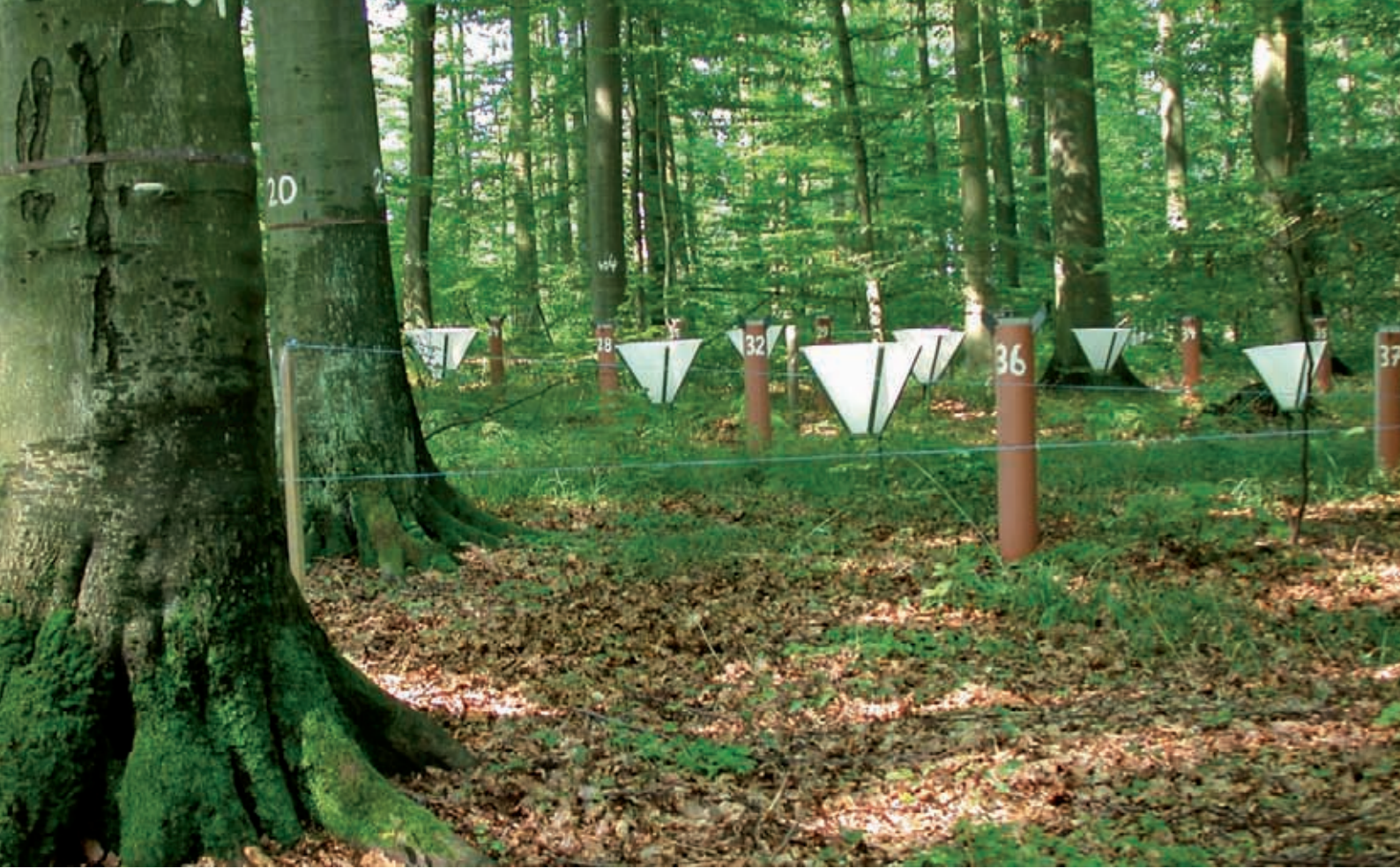
Colectores de deposición (rojos) y de desfronde (blancos) en una parcelas de Nivel II.
