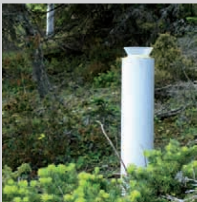
Colectores de deposición bajo dosel de copas en Grecia
