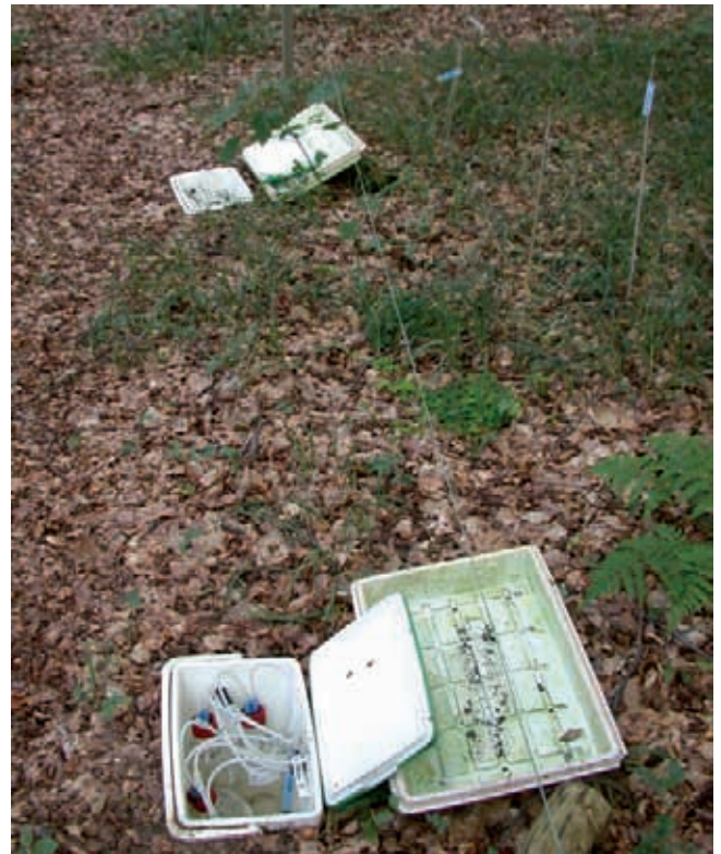
Los lisímetros extraen agua, que se llama solución del suelo, para análisis en laboratorio. La solución del suelo reacciona a la deposición y juega un papel importante en los ecosistemas forestales. Es, por ejemplo, esencial para la captación de agua y nutrientes por las plantas.
