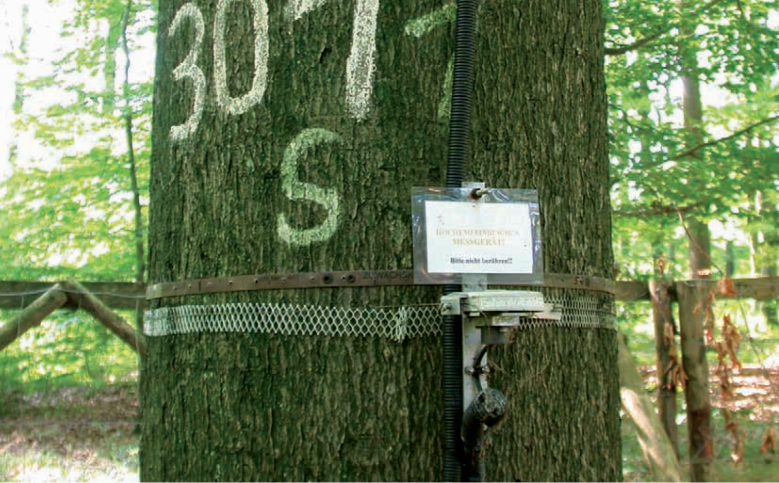
Banda permanente de medición de la circunferencia en un haya.
