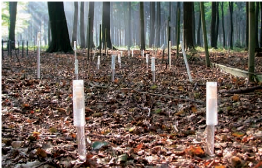
Un dispositivo de tensiómetros de suelo diseñados para evaluar la variabilidad en la tensión de agua del suelo en una parcela de Nivel II en Alemania.
