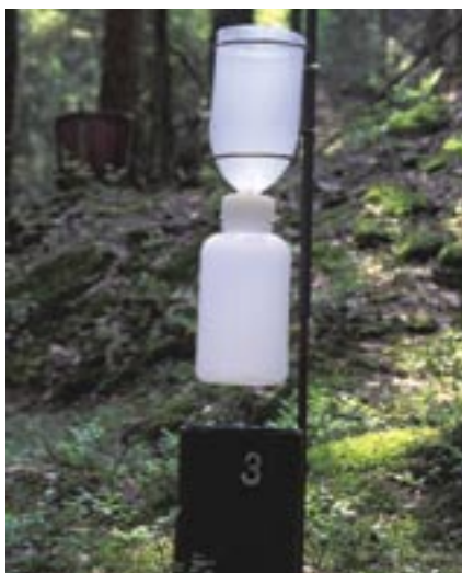
Equipamento de medição da colheita de deposição líquida em povoamentos florestais.
