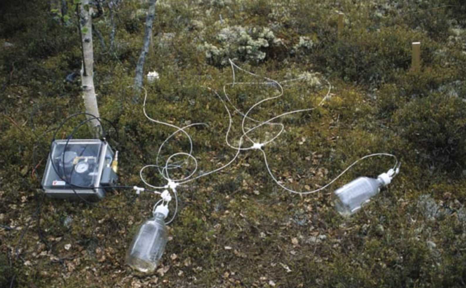
Os lisímetros extraem água de diferentes camadas do solo
