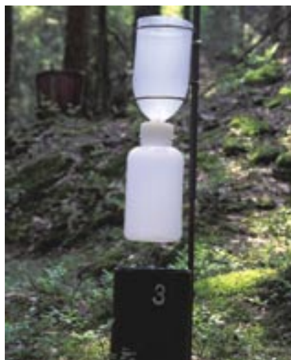
Sammelbehälter für feuchte Depositionen in Waldbeständen
