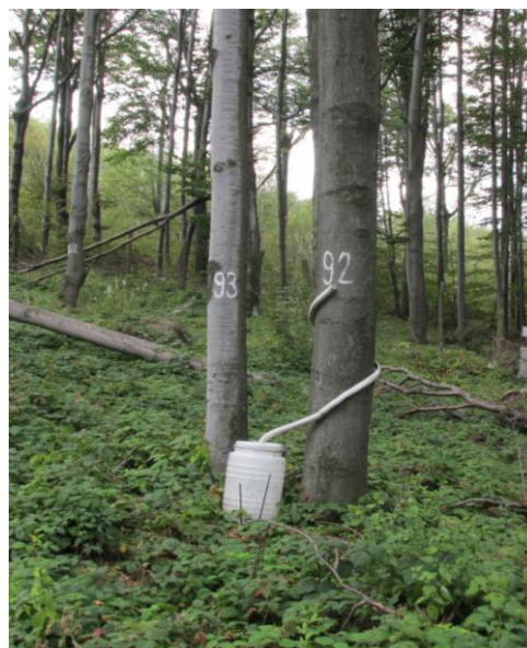
Слика 429. „Stemflow колектор“ на огледном пољу, БИТ Ниво 2, Црни врх, септембар 2016 Figure 429. `Stemflow` collector on the Level II sample plot on Crni Vrh, September 2016
