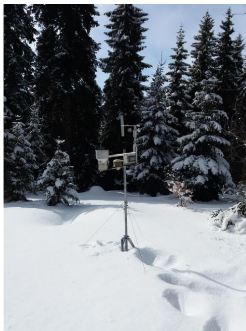
Слика 351. Метеоролошка станица за аутоматска мерења микроклиматских услова, Огледно поље Нивоа 2, Копаоник Figure 351. Weather station for automatic measurements of microclimatic conditions, Level II sample plot Kopaonik
