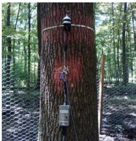
Слика 457. Постављање електронског дендрометра. Figure 457. Electronic dendrometer.
