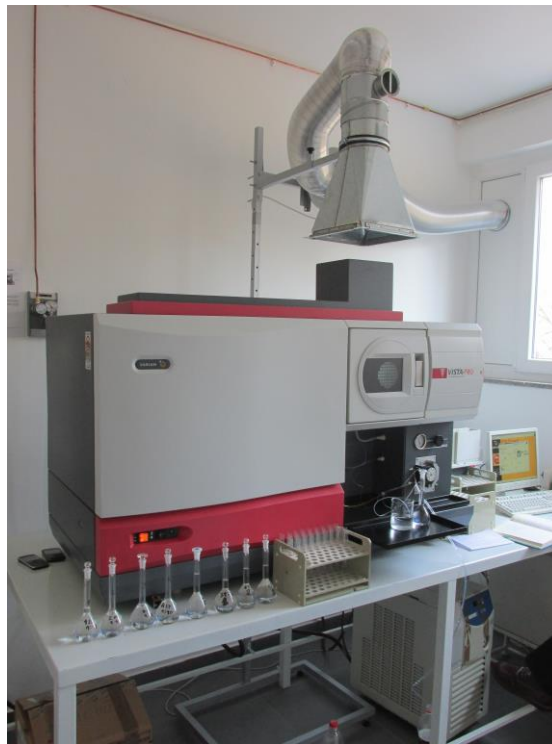
Слика 427. Одређивање количине хранљивих материја у лисном опаду (биланс кружења хранљивих материја у екосистему) за Копаоник, Црни врх и Мокру Гору ICP – AES Spectrometer у лабораторији Института за шумарство, Београд
