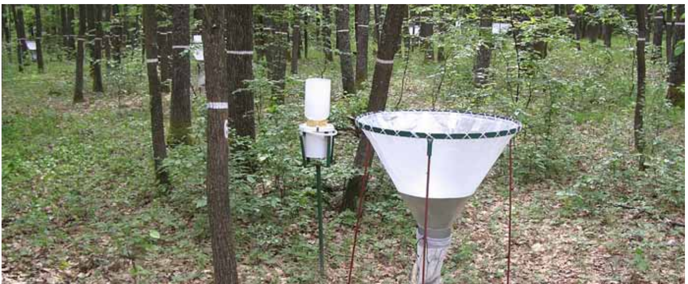
Sammler für Streufall und Bestandesniederschlag auf einer Intensivuntersuchungsfläche in der Slowakei.
