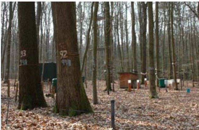
Level II-Fläche in Deutschland mit ständiger Umfangmessung (Vordergrund), Messgeräten für Bestandsniederschlag und Stammablauf.
